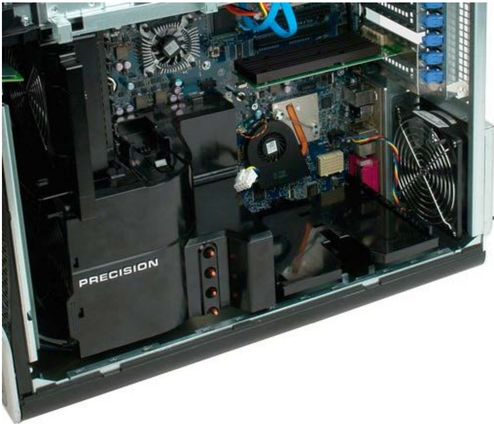
7. Koppel de kabel van de ventilator voor de dubbele processor los van de kaart met de dubbele processor.
