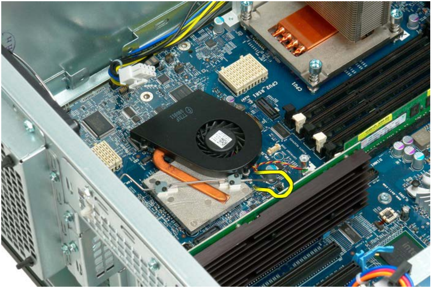
6. Verwijder de chipsetventilator uit de computer.
